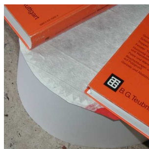
Abb. 17 Andrücken der Klebelaschen bei der 2. Deckseite durch Beschweren mit Büchern
